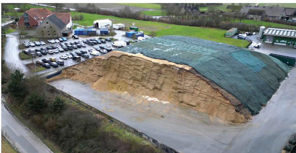
Bild 1: 23.000 t Maissilage bildeten den ursprünglichen Speichervorrat für den Jahresbetrieb der Biogasanlage in Melle
