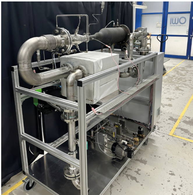
Hochdruckprüfstand zur Untersuchung der Brennkammer und weiterer Komponenten ohne Wärmeisolierung
