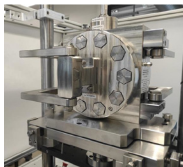
Wasserstoffautoklav für Risswachstums- und Bruchzähigkeitsversuche in Druckwasserstoff bis 200 bar
