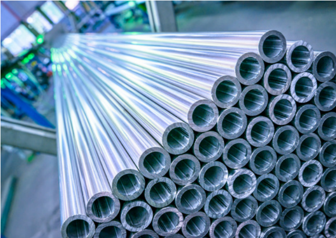
Im Laserverfahren oder per WIG-Schweißen produzierte Edelstahlrohre
