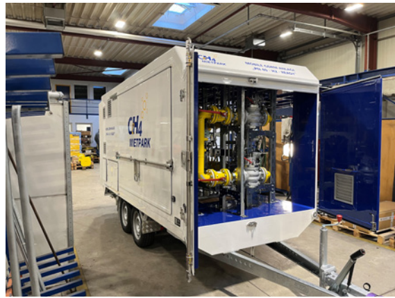
Auf dem Freigelände, B.01, zeigen die Celler die neue mobile GDRM-Anlage von CeH4 mit der Druckstufe PN 40, die außerdem H 2 -ready ist
