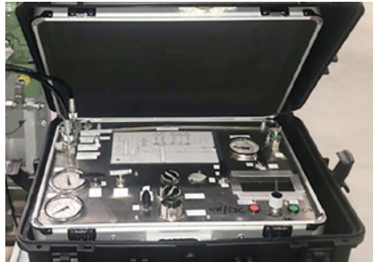
Prototyp DRE3-Koffer für methanemissionsfreie Prüfungen an Gasanlagen nach G495
