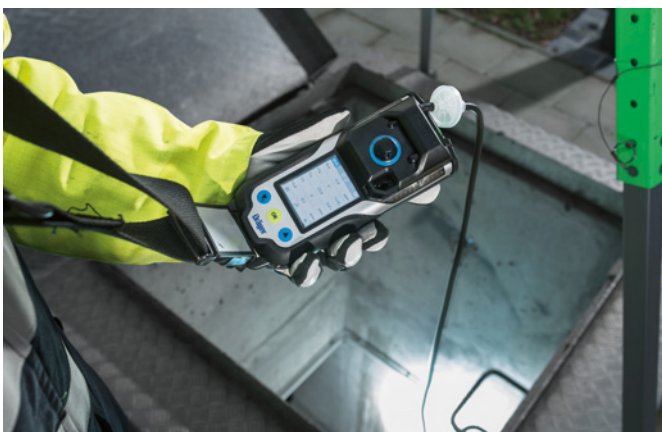
Bild 2: Tragbares Gaswarngerät nach T021/T023 für das Freimessen nach DGUV G. 313-00
