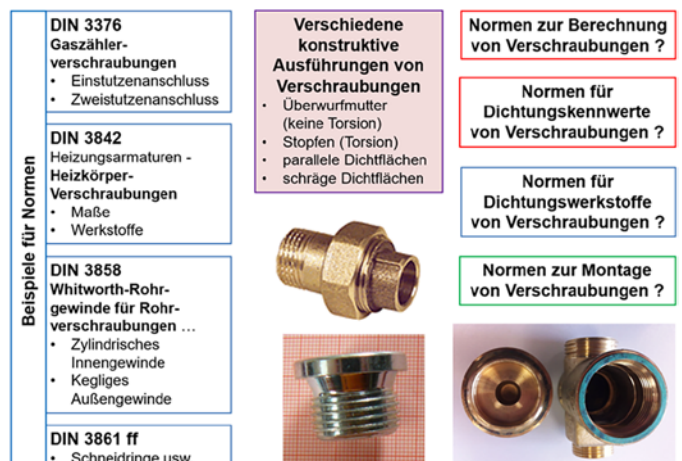
Bild 2: Technische Regeln zur Verschraubung
