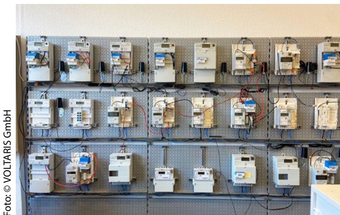
Bild 1: VOLTARIS testet verschiedene Mehrzähler-Anbindungsvarianten in den eigenen Prüfräumen und in Pilotprojekten
