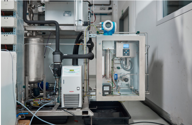
Bild 2: Enapter setzt auf eine kombinierte Lösung mit dem TDLAS-Gasanalysegerät J22 und dem Sauerstoffanalysegerät OXY5500
