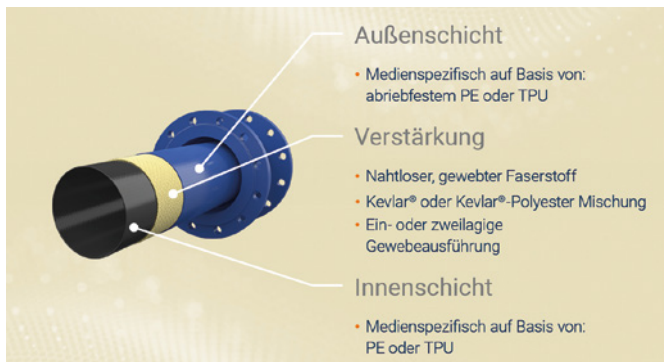
Bild 1: Dreischichtiger Aufbau des Primus Liners
