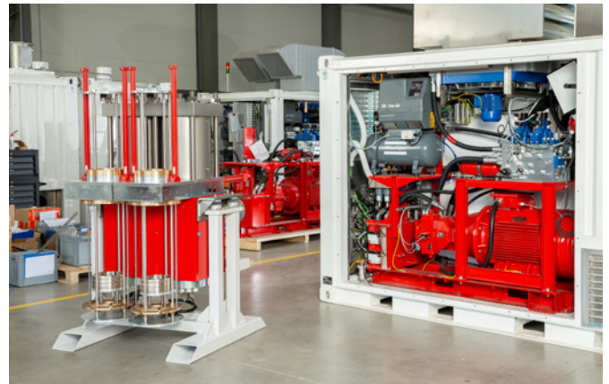
Bild 1: Das Herzstück der Maximator Hydrogen Wasserstofftankstellen: MAX Compression 2.0 mit patentierter Automatic Seal Exchange Technologie
