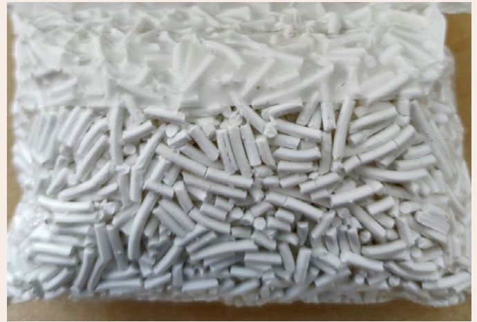
Bild 3: (a) MefHySto-Mitarbeiter am Versuchsstand der BAM für Hochdruckadsorption von Wasserstoff in MOFs bei kryogenen Temperaturen zwischen 77 und 100 K (b) Extrudiertes MOF-Referenzmaterial ZIF8 für den bevorstehenden Ringversuch zur Kryoadsorption von Wasserstoff
