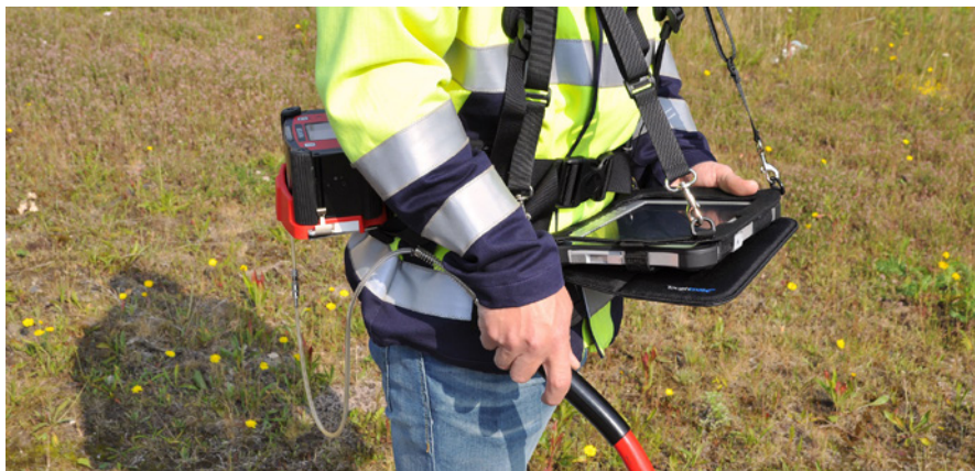
Bild 1: Gasspürer:innen oder Lotsende können Pi NOTE mit den Gasmessgeräten Laser HUNTER, HUNTER oder GOLIATH koppeln. Die Verbindung baut sich über Bluetooth auf Foto: Esders GmbH
