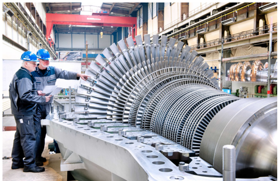
Bild 3: Mit Dampfturbinen von MAN Energy Solutions kann die im Flüssigsalz gespeicherte Energie wieder zur Stromerzeugung genutzt werden
