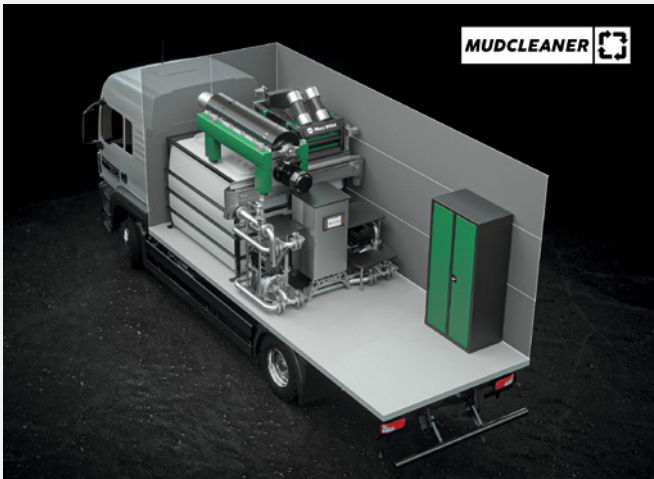
Bild 1: Der wendige 2-Achser mit Hydro-Drive ist geländetauglich und ermöglicht ein Gesamtzugkonzept von Lkw und Bohranlage nach den gesetzlichen Vorgaben Foto: Max Wild
