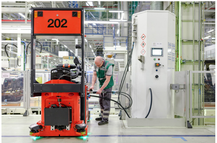
Bild 1: Betankung eines wasserstoffbetriebenen Routenzuges mit der WEH-TK16 H 2 35 MPa
