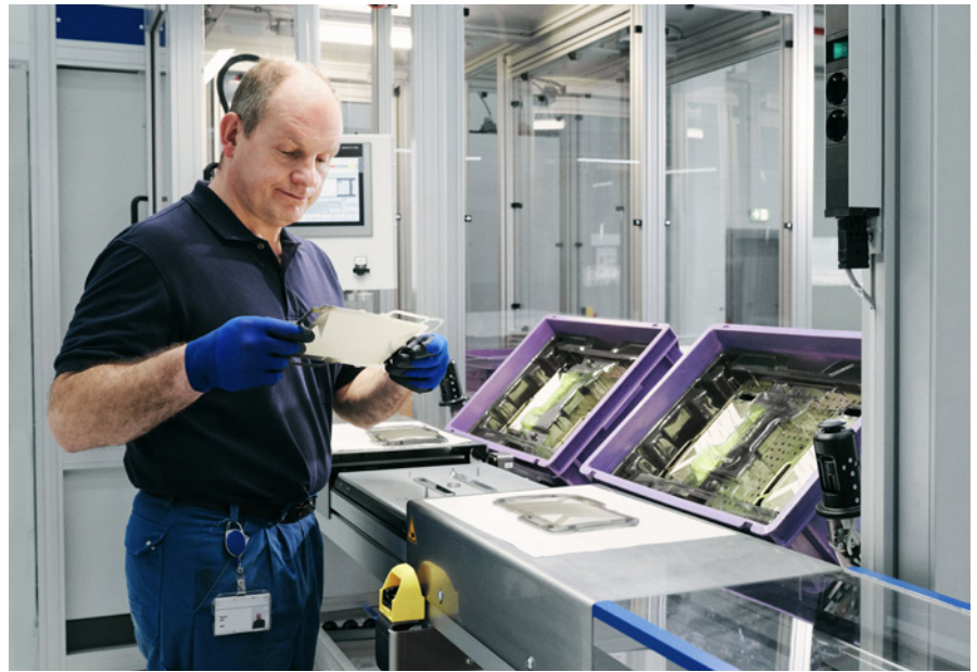
Bild 1: Die Bipolarplatte, Kernelement eines Brennstoffzellenstacks, regelt die Zufuhr von Wasserstoff und Luft sowie die Abfuhr von Wasser
