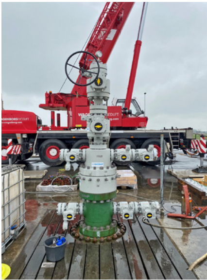
Bild 3: Hartmann Bohrlochkopf mit Kugelhähnen für eine Wasserstoff-Testbohrung in den Niederlanden
