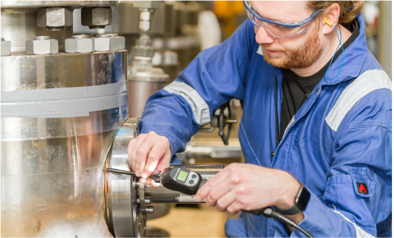
Ein umfassender Drucktest mit Wasserstoff gibt Sicherheit, dass die Grenzwerte eingehalten und flüchtige Emissionen minimiert werden
