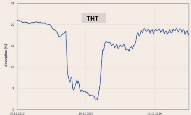
Bild 5: Konzentrationsverlauf bei Störung der Odorierung
